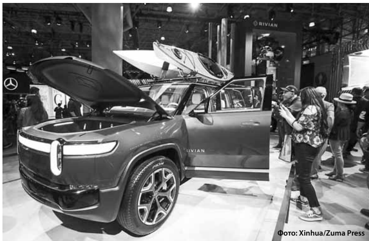
В электромобиле Rivian используется схема скейтборда, где батарея располагается под полом, а к каждому колесу подключен отдельный двигатель.
